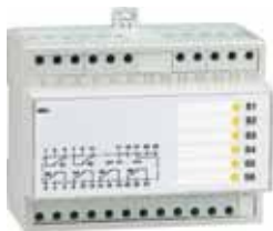
Programovateľné kontakty M6C: externé relé pripojiteľné k ističu so šiestimi nezávislými prepínacími kontaktami riadenými z ističa cez trojžilový kábel (maximálna dĺžka je 10 metrov).
