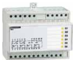
Programovateľné kontakty M6C: externé relé pripojiteľné k ističu so šiestimi nezávislými prepínacími kontaktami riadenými z ističa cez trojžilový kábel (maximálna dĺžka je 10 metrov).
