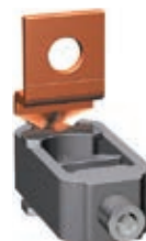
Svorka pro neupravený kabel Cu/Al 2 × 50 až 185 mm².
