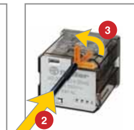
C: možnost 6, 7, 74 LED pro DC + ochranná dioda (+ na A1/A)
